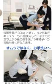
移乗サポートロボット Hug L1 (FUJI) は、ベッドから車椅子、車椅子からお手洗いといった座位間の移乗動作や、脱衣場での立位保持をサポートするロボットです。背面重量が30kgと軽く、また移動用キャスターも6個使用していますので立ち上がり後のお手洗いや車椅子への移動も楽々となります。
